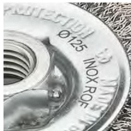
Лазерная маркировка щеток
